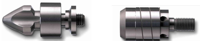
3. ÁBRA HAGYOMÁNYOS CSIGACSÚCSOK GYŰRŰS, GOLYÓS FORRÁS : SUMITOMO (SHI) DEMAG
